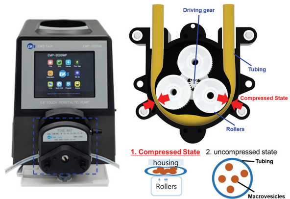
Fig. 1 상업용 연동펌프 및 구동 원리
